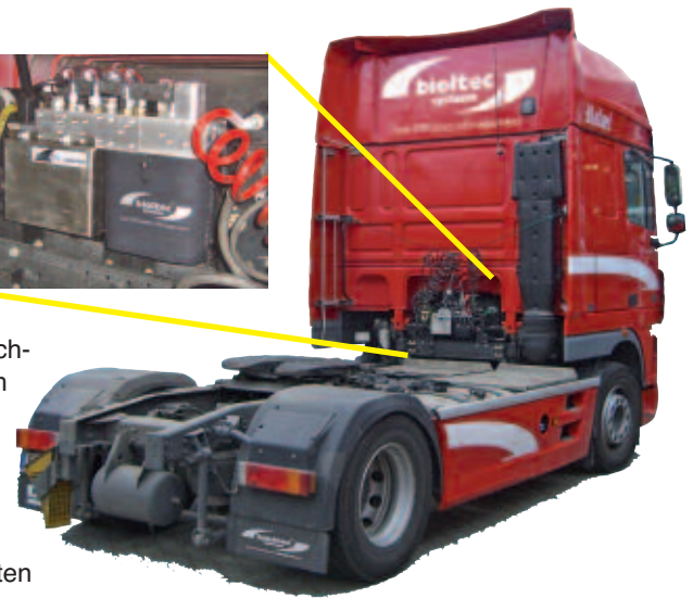
Diese Sattelzugmaschine DAF XF105 wurde mit dem System „Bioltec Vario 2.0“ ausgestattet. Es ist geeignet für Kraftstoffe mit einem Stockpunkt über 30 Grad. Werksfoto
